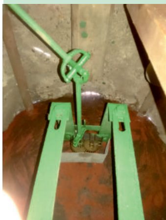
Kardan náhonu ruček a ručkový převod, Nahořany, kaple Sv. Rodiny, věž;
