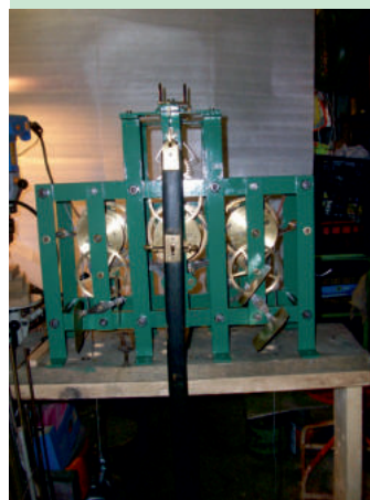
Restaurovaný stroj věžních hodin z Nahořan v dílně; Foto Karel V. Nývlt
